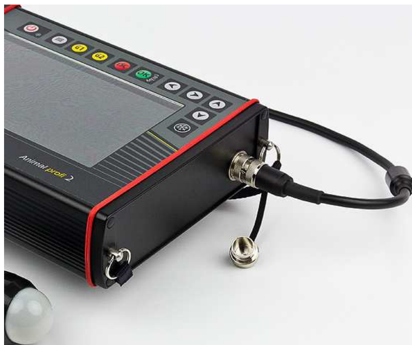
Abbild des richtig geschraubt und gesperrten Schallkopfes.
