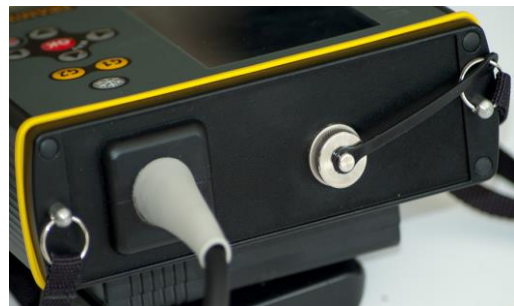
Abb.1a. Anschluss für Sondenleitung. Übertragungsanschluss zum PC
