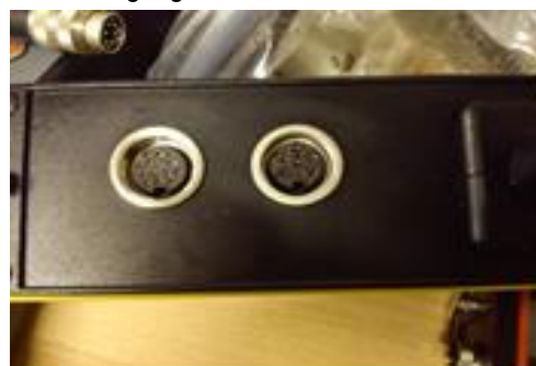
Abb.1b Version mit Brille. 5-Pin Übertragungsanschluss zum PC und 12-Pin Brillenanschluss
